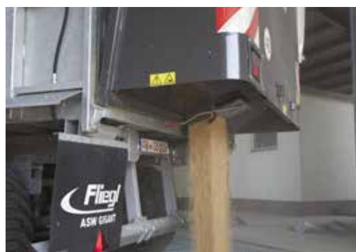
Velkorozměrový kryt se šoupátkem pro jádro (zrní) v sériovém provedení
