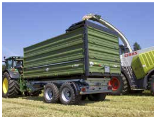
Hydraulická zadní stěna s integrovanými bočnicemi
