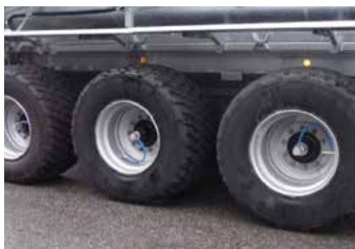
Zařízení pro regulaci tlaku v pneumatikách, pro nasazení šetrné k půdě na poli
