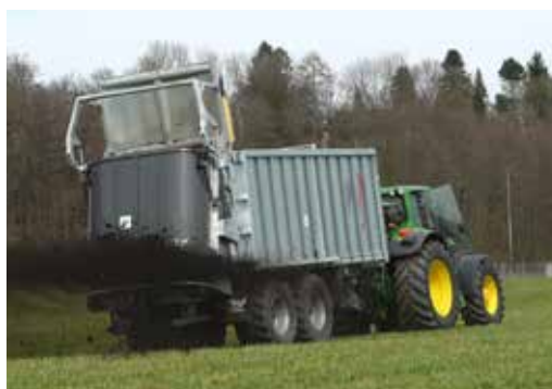
Rozmetadlo »Profi« se zavřeným krytem -rozmetací šířka cca 22m
