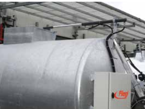
Hydraulické posuvné víko otvoru 700 x 700 mm
