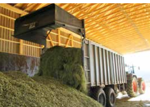
Vyhrnování – žádné sklápění – bezproblémové i v nízkých budovách
