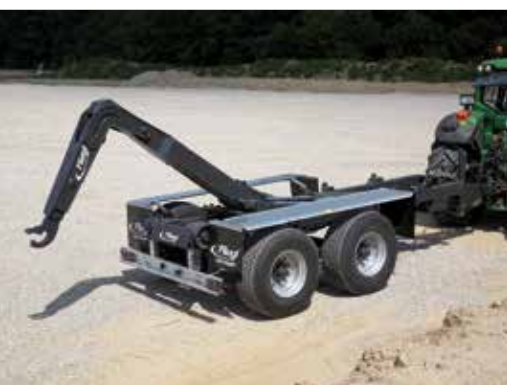
Tandemový HKL se sklápěcím ramenem / síla zdvihu 18 tun
