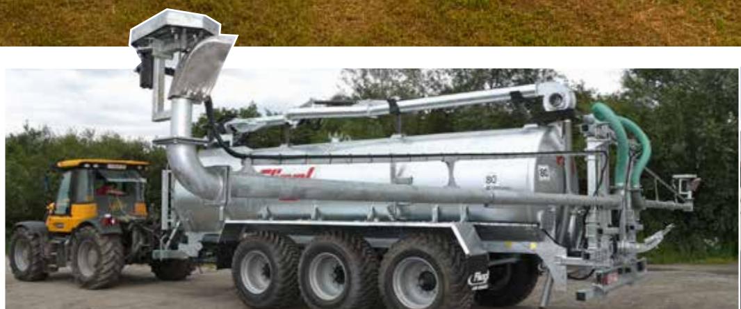
Rozstřikovač s tryskami s maximální pracovní šířkou od 12 do 30 m
