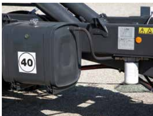
Palubová hydraulika 60 litrů (volitelně 90 l) poháněná pomocí průseku hřídele s hydraulickou pumpou a nádrží na olej
