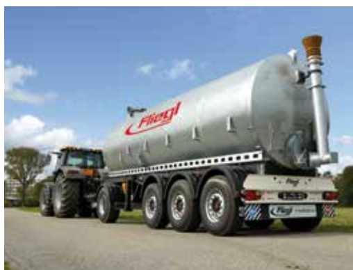
Přepravní cisterna o objemu 20-30 .000 litrů s a bez vývěvy
