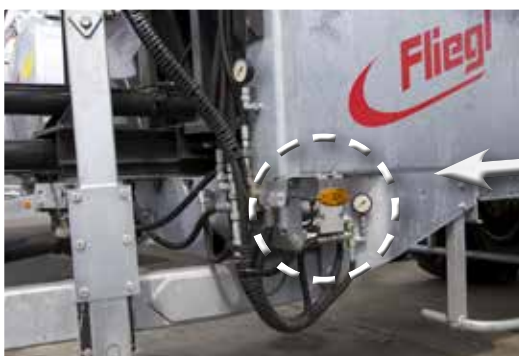
Regulace posuvu volitelně mechanicky nebo elektrickým potenciometrem
