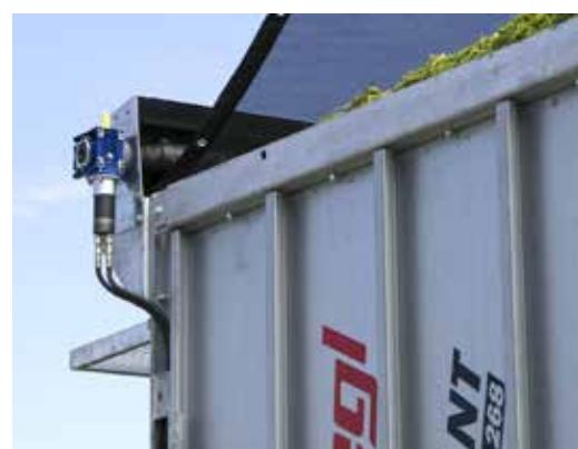
Hydraulicky poháněný olejový motor pro zatažení zakrývací sítě
