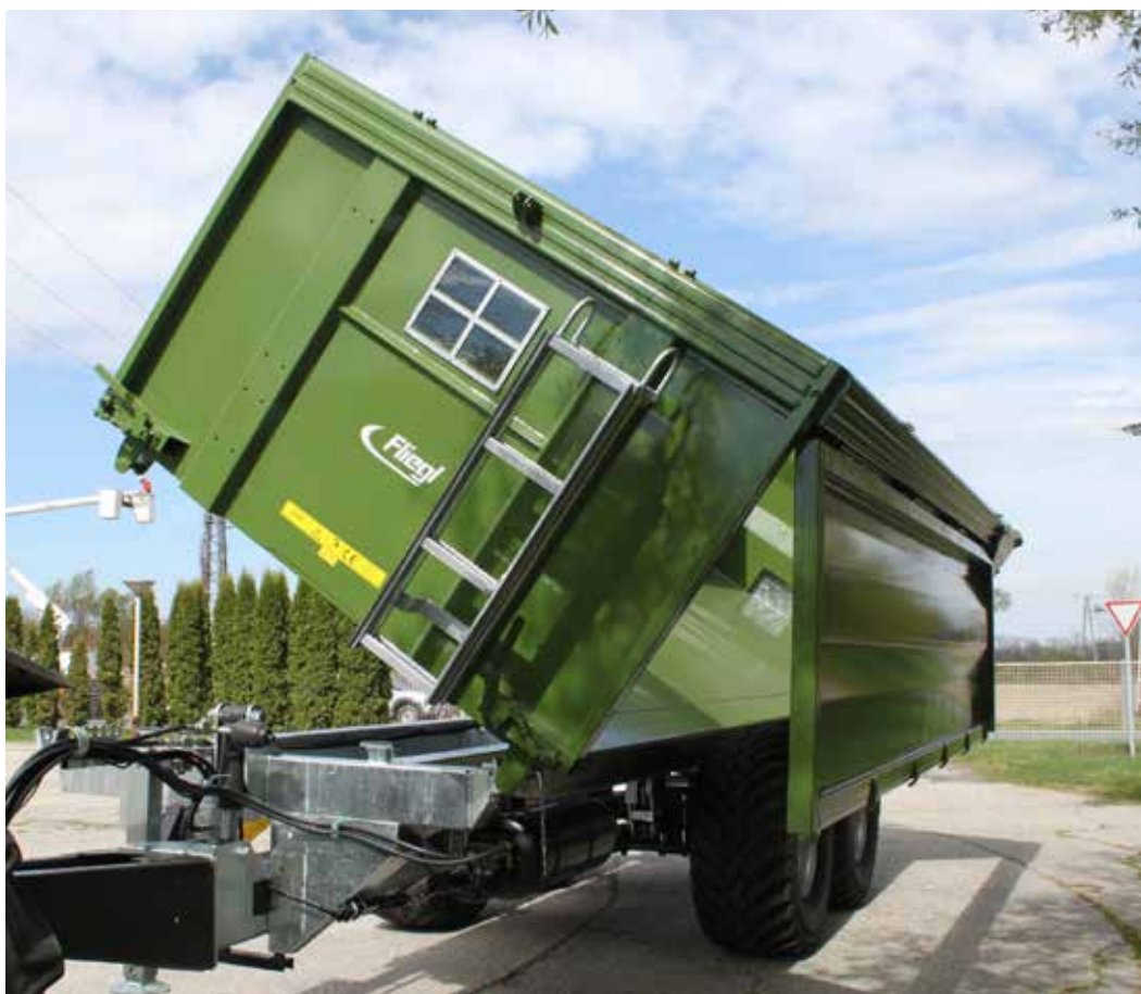
Tandemový – třístranný korbový sklápěč, výjimečně robustní díky zesílené bočnici.
