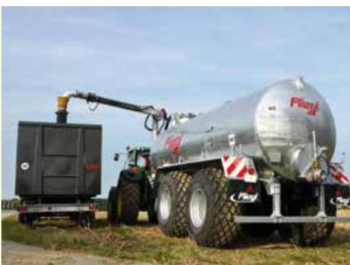
Mobilní kontejner pro umístění na souvratí pole, dvouosý, objem cisterny 30 m 3
