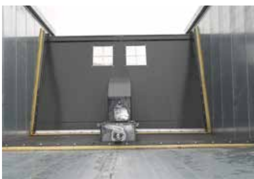
Těsnící lišty kolem dokola : pomocí speciálního těsnění vyhrnovacího mechanismu z polyeteranu je Gigant osazením těsnění v úhlu 45 stupňů, které je tlačeno naloženým materiálem ke stěnám, absolutně těsný .
