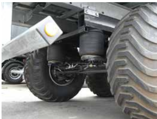
Volitelně: vzduchové pérování s automatickým snížením úhlu sklopení
