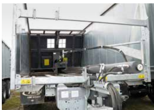
Masivní a spolehlivý vyhrnovací systém - žádné choulolistivé opotřebitelné díly.
