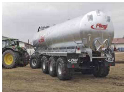
Čtyřnápravová vakuová cisterna 25 000 litrů s točnicí
