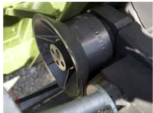
Velké ocelolitvinové odvíjecí válečky (Ø 310 mm) s velkou příčkou centrování – ulehčují vytáhnutí kontejneru
