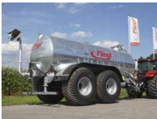
Profesionální řada 18000 litrů s výřezem pro kola, v provedení jako čerpadlová nebo vakuová cisterna
