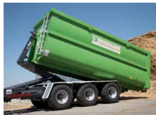
Tridemový HKL 29 s teleskopickým ramenem / síla zdvihu 26 tun
