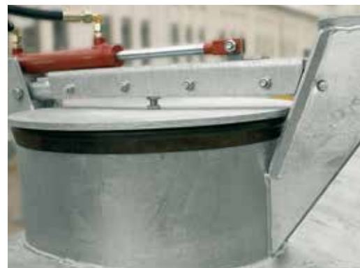
Hydraulicky ovládaný horní otvor
