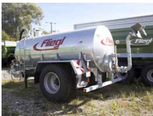
Jednonápravová cisterna jako verze 40 km/h
