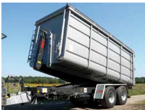
Tandemový HKL 22 s teleskopickým ramenem / síla zdvihu 26 tun
