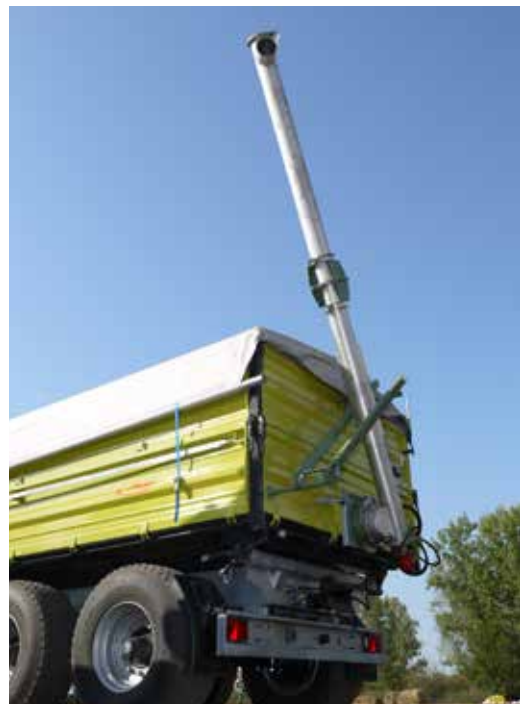
překládací šnekové dopravníky 4000 mm
