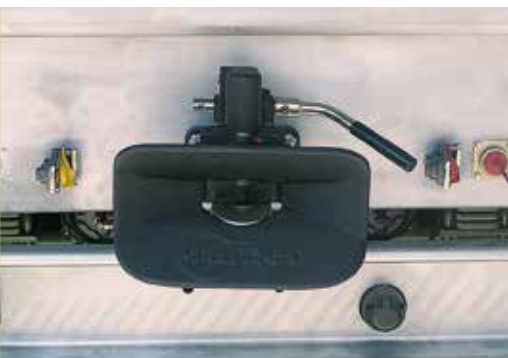
Automatická spojka přívěsu s hydraulickým a brzdovým připojením pro druhý přívěs.
