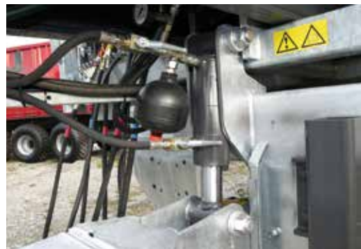
Hydraulické odpružení oje od modelu ASW 258 – přípojná výška plynule stavitelná v rozsahu 200 mm
