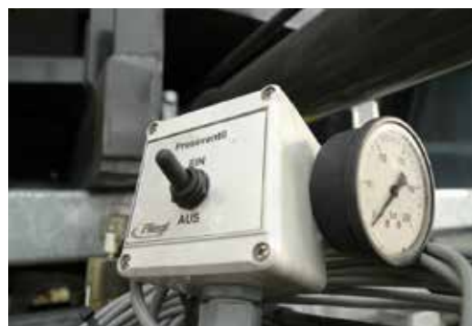
Automatický lisovací ventil – tak je automaticky při stlačování nakládaného materiálu, například siláže, regulován tlak
