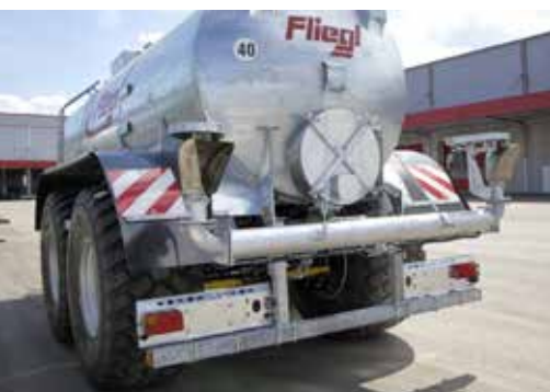
Dvojitý kyvadlový rozprašovač – hydraulický
