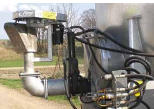
Cílené a lepší rozdělení s hydraulickým kyvadlovým rozstřikovačem. Pracovní záběr od 10 do 18 m.
