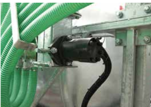
Olejový motor pro šnekový rozdělovač s meziložiskem pro menší opotřebení a dlouhou životnost
