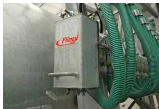
Schránka pro cizí tělesa – mechanické nebo hydraulické vyprazdňování
