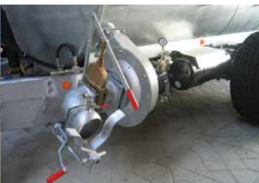
Hydraulicky poháněný turboplnič s 6" rychlospojkou (za příplatek)
