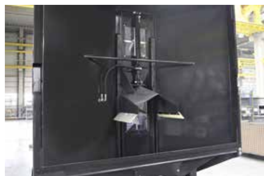
Hydraulický přítlačný shrnovač umožňuje v naloženém stavu kompletní vyprázdnění překládacího šnekového dopravníku
