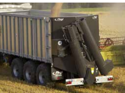
Překládací trubka o průměru Ø 400 mm Hydraulicky sklopná
