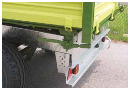
Centrální zavírání vzadu, sériově od EDK 40.
