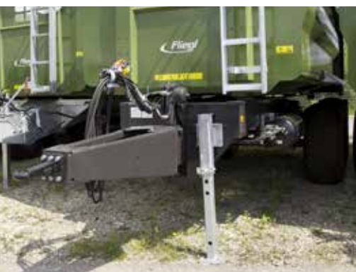
Hydraulické odpružení oje od modelu TMK 256
