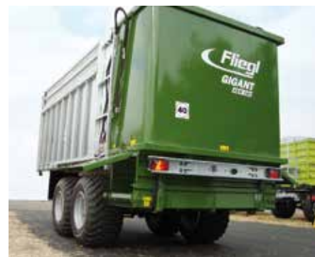
Velkoobjemová zadní stěna s vykládkovým rozdělovačem. Zabudovaný příčný dopravník a rozdělovacím válcem se starají o nerušené dávkování krmiva ve stáji je možné vyhazování směrem vlevo a směrem vpravo
