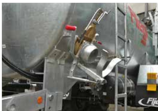
Nejjednodušší připojení systémem rychlospojky
