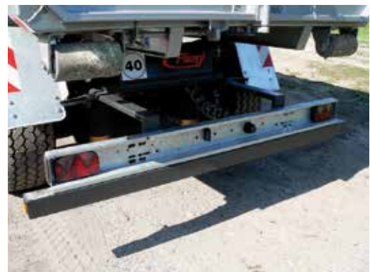
Volitelně: výsuvná ochrana proti podjetí pro delší kontejnery
