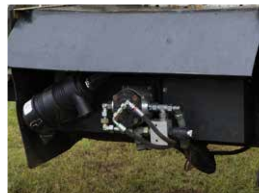
Pístový kompresor se vzduchovým výkonem až do 3 m 3
