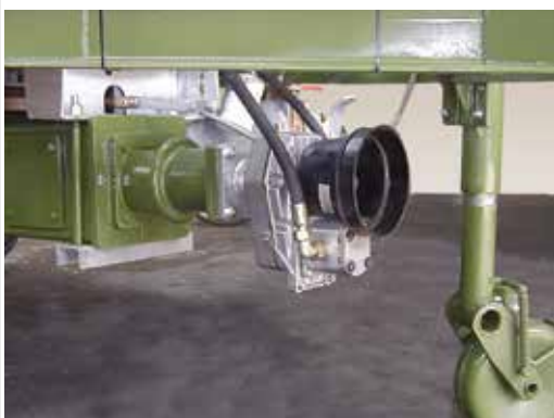
Čerpadlo s vlastní hydraulikou
