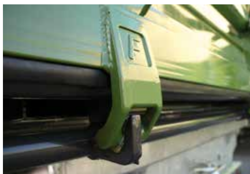
Centrální zavírání postranní, sériově od EDK 60, od délky korby 4.500 mm 6-ti násobné zavírání, celistvý nezastřížený korbový profil.
