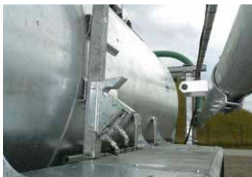
Transportní pojistka pro silniční provoz s hydraulickým zajištěním a odjištěním
