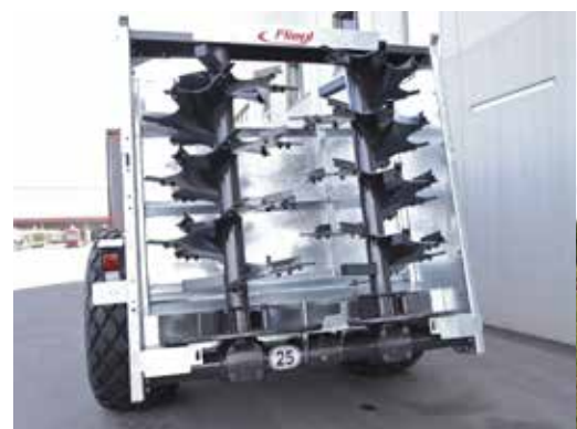
Robustní rozmetadlo s pracovní šířkou 12 m.
