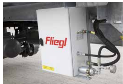
Ovládací jednotka – chráněná proti stříkající vodě
