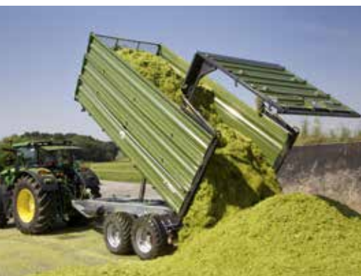
Silážový sklápěč s hydraulickou zadní stěnou
