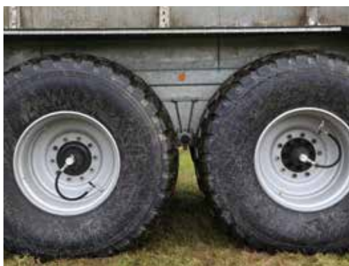
Zařízení k regulaci tlaku v pneumatikách, pro nasazení šetrné k půdě na poli, se zařízením s jedním nebo se dvěma vedeními.
