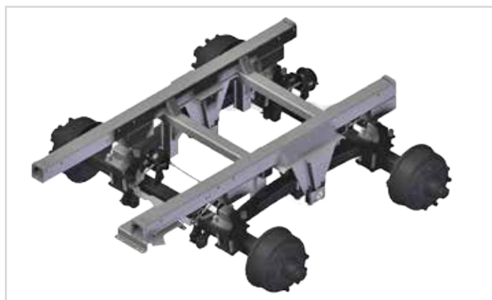
Tandemový agregát Titan pro lepší vyrovnání terénních nerovností, bez mazání a bez údržby.
