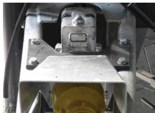
Palubová hydraulika 60 litrů (volitelně 90 l) poháněná pomocí průseku hřídele s hydraulickou pumpou a nádrží na olej
