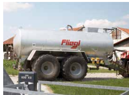
Odstředivá cisterna „Light“ 18 000 litrů s pneumatikami 700/30,5, vlastní váha 5700 kg
