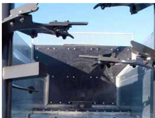
Nejmenší opotřebení díky hydraulickému posuvnému systému – žádné drapákové dno.
