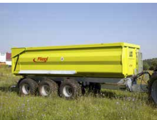
Korbové sklápěče Tridem s délkou korby (muldy) 7,15 m
