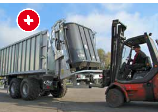
Pomocí vysokozdvížného vozíku lze během 10 minut rozmetadlo jednoduše sundat
