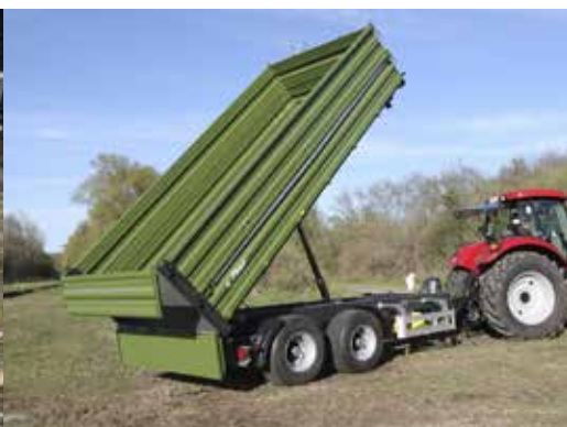
Typ TDK 160 s hydraulickým šterkovým zadním výklopným čelem
