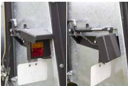
Při otevření přítlačného shrnovače se uskuteční samočinné zakrytí zadního světla
